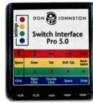
Für das iPad ist Scanning mit ein oder zwei Schaltern die einzige alternative Eingabemöglichkeit, wenn keine direkte Ansteuerung möglich ist.
